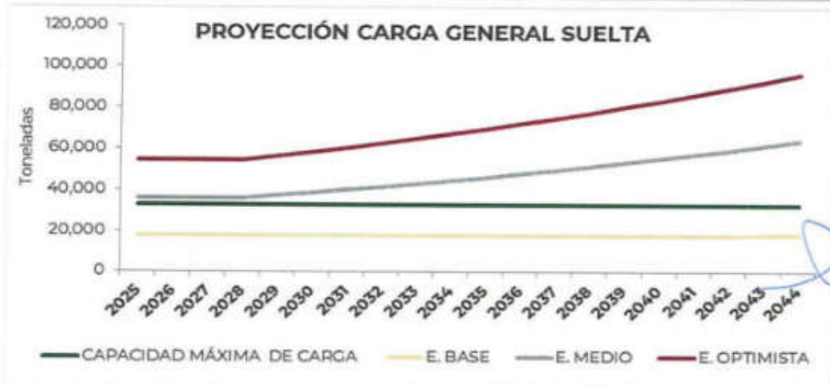
Figura 30 Capacidad de Puerto Chiapas para el movimiento portuario de la línea de negocio de carga general suelta por tipo de escenario. Fuente: ASIPONA Puerto Chiapas, 2024.
